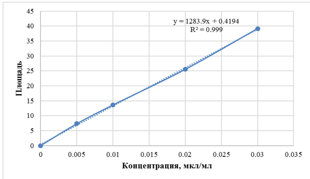
Рисунок 33 – Вид калибровочного графика и уравнение прямой с учетом включения точки ПКО ЭС
